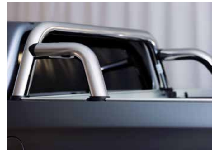
L'arceau de protection en cas de tonneaux en acier chromé prolonge non seulement la cabine mais convient aussi parfaitement pour fixer les objets très longs.
