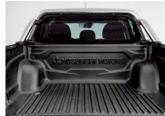
Revêtement du plateau de l'espace de chargement (bac de benne), protège des dégâts et crée une surface antidérapante.
